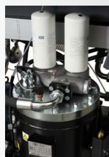
zbiornik separacyjny z wbudowanym wymiennikiem ciepła dla osuszacza
